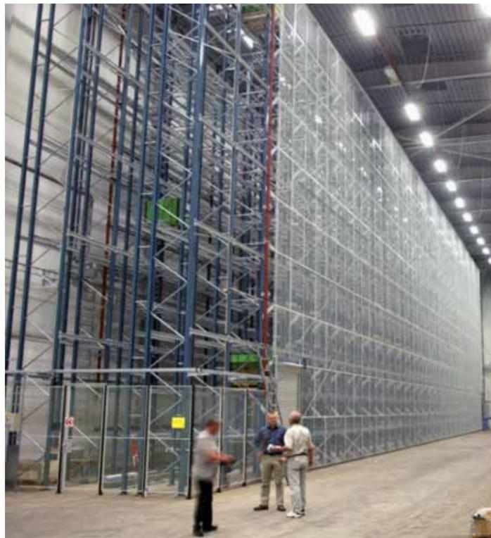
SafeStore-Giterrückwand, 12 Meter hoch, 55 Meter lang, als Teil der Schutzvorkehrungen in einem Aerosollager. Die Ausführung der Giterrückwand erfolgte in Spezialfarbe und mit massiven Elementaufnahmen, um den hohen Anforderungen des Kunden zu entsprechen.
